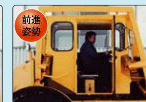
ダブルステアリング方式(シートが180°回転)
