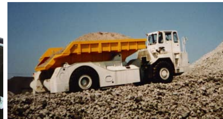
ダブルステアリング方式(シートが180°回転)
